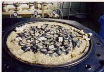
図-7 高水圧下(水圧290m)でのパネルと単粒砕石接触面との接触状況
