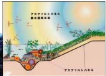
図-19 パネルを組み合わせたビオトップ景観護岸モデル
